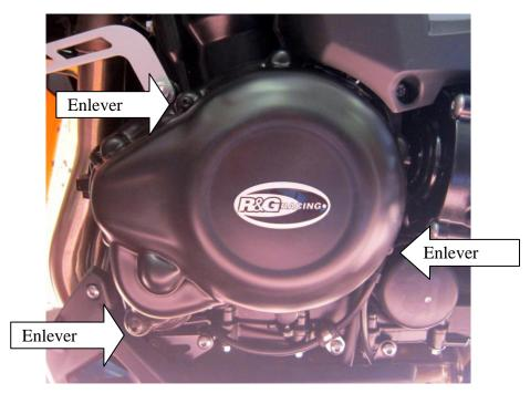
Le kit doit contenir: 1 x Protection carter moteur (ECC0136) 3 x M6x35mm Longs boulons à tête ronde
