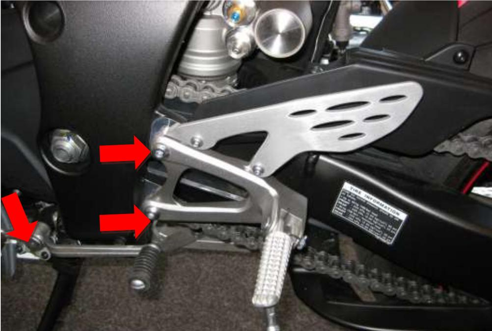
Enlever le train arriere d'origine et le levier de vitesses, mais garder l'arbre de transmission d'origine et le connecteur boîte de vitesses.
